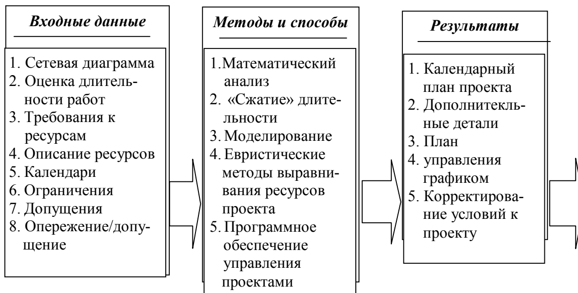
Рисунок 3.13 — Составляющие системы разработки календарных планов
