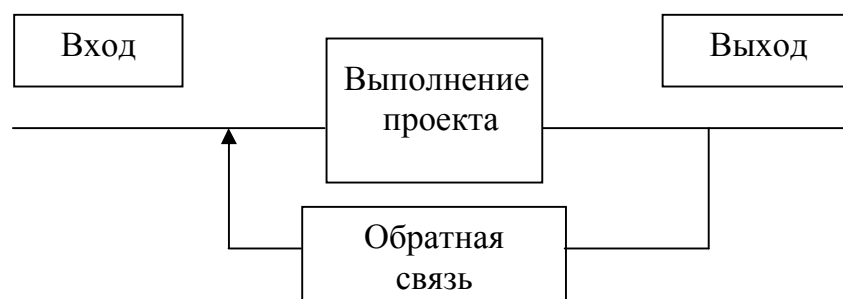
Рисунок 2.5 — Система управления с обратной связью
