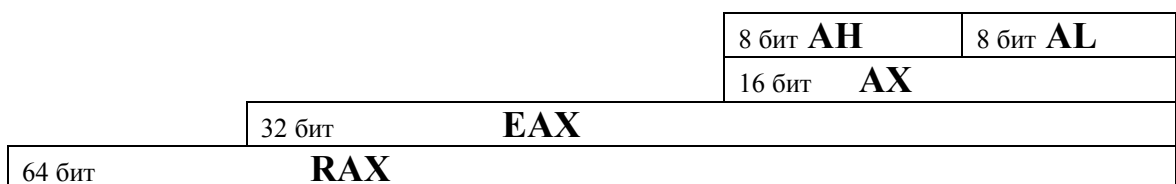
Рисунок 1.3 — Принцип формирования имен регистров микропроцессора
