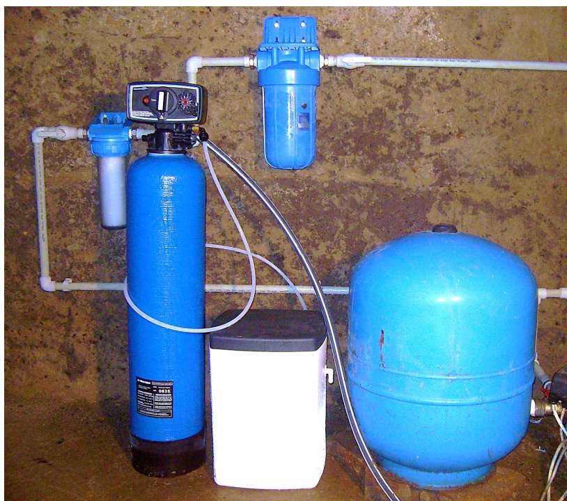
Рисунок 4.23 — Экспериментальная установка для исследования очистки воды от нитратов путем ионного обмена
