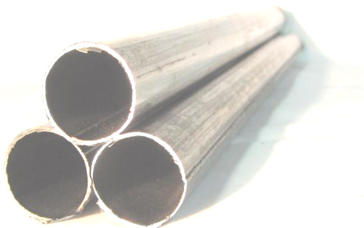
Рисунок 7 Тонкостенные трубы после разделения на части по двухстадийной схеме резки на гидравлических летучих ножницах
