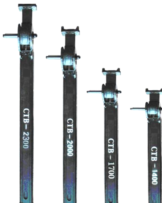
Рисунок 3 Индивидуальная механическая стойка трения STV (СТВ)
