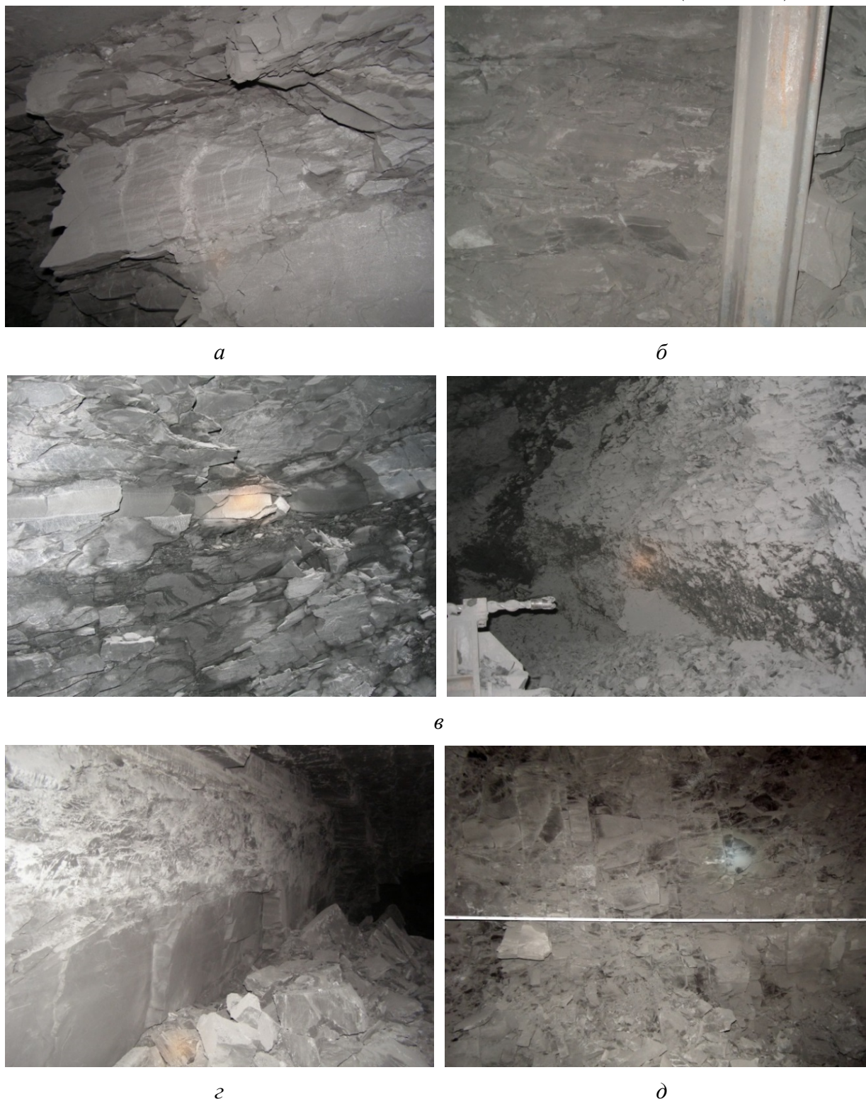
Рисунок 2 Фотофрагменты уплотнённых пород выработанного пространства шахт: а и б — им. Ф. Э. Дзержинского при проведении вентиляционного уклона № 3 по лавам соответственно № 3 и № 9; в — «Красный партизан» при проведении западного
