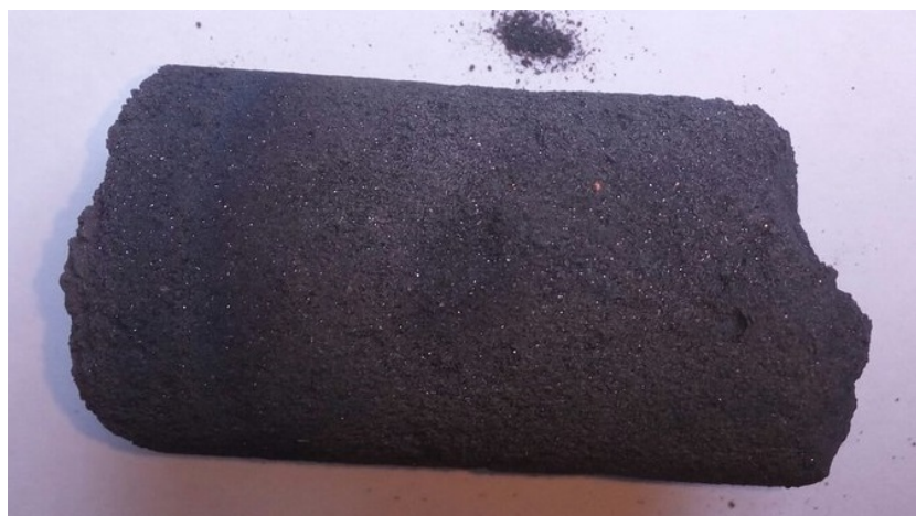
Рисунок 1 Губчатое железо, полученное из железорудного концентрата и антрацита
