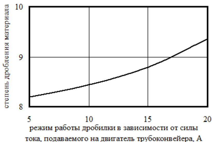
Рисунок 5 График зависимости степени дробления от режима работы дробилки
