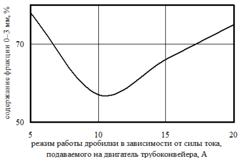
Рисунок 4 График процентного содержания фракции 0–3 мм в готовом продукте в зависимости от режима загрузки
