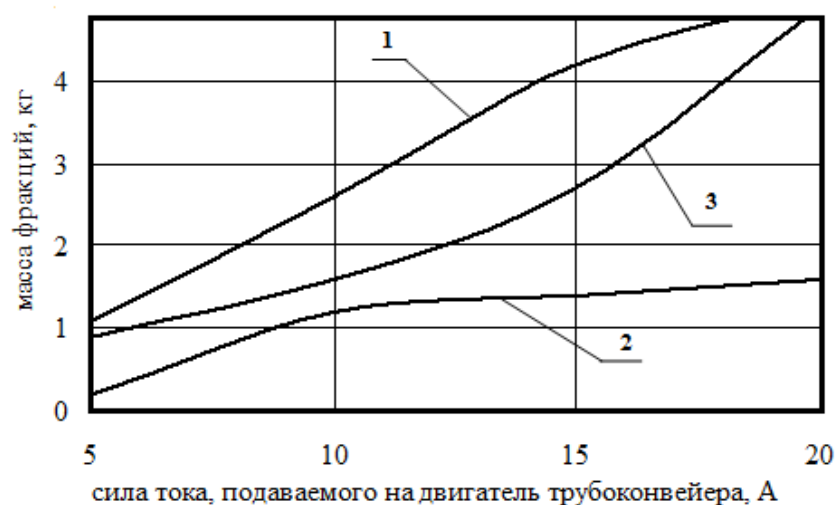
Рисунок 1 График зависимости содержания фракций в шихте при различных режимах загрузки дробилки
