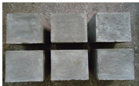
г) образцы после снятия формы
