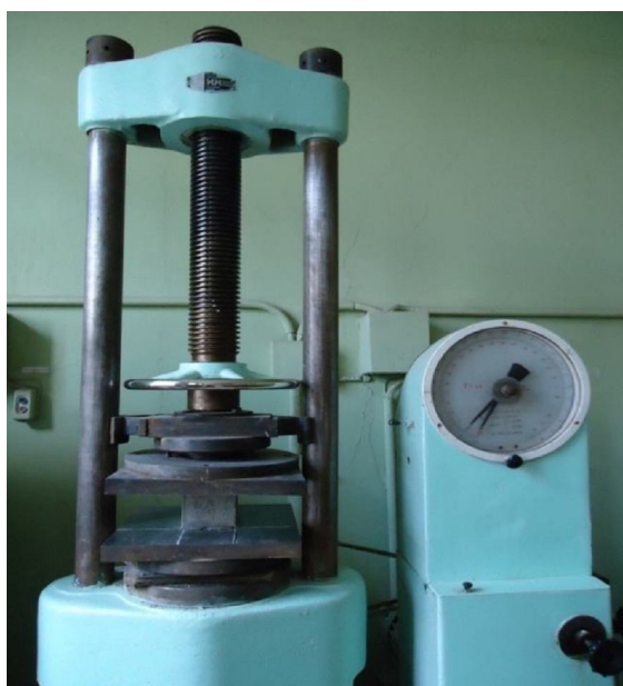
Рисунок 2 – Фрагмент определения прочности на сжатие
