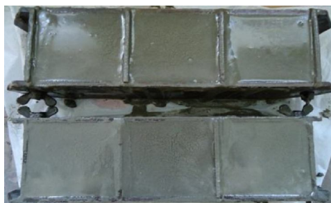
б) формы после заполнения смесью
