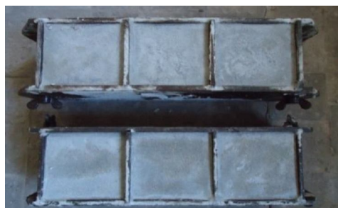
в) формы после затвердения смеси
