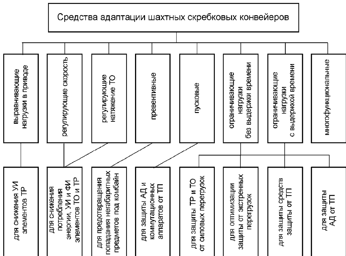
Рисунок 1 - Функции и назначение средств адаптации скребковых конвейеров
