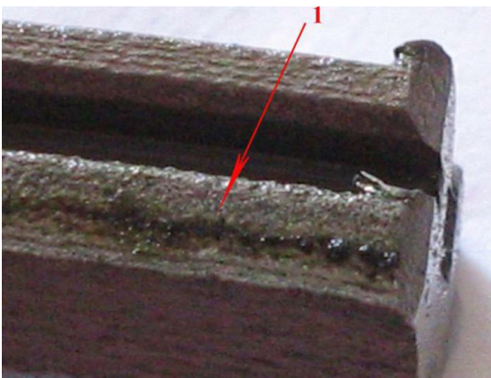
в) оксидообразные коррозионные поражения на границе покрытие-основа
