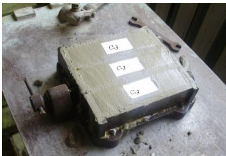
Рисунок 3 – Свежеприготовленные образцы цементно-шлаковой смеси в опалубке
