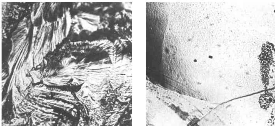
Рисунок 1 – Характер разрушения сплавов ЭЛПЕ ПО №№ 2 и 3 (табл.1)
