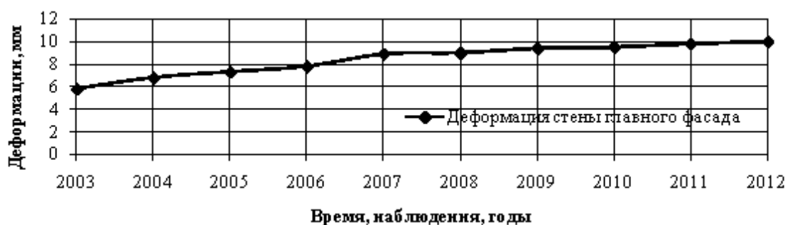
Рисунок 5 – График мониторинга за деформациями жилого дома по ул. Смоленская, 1 в г. Брянка
