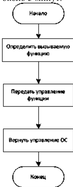
Рисунок 6 - Блок-схема алгоритма работы диспетчера класса обертки
