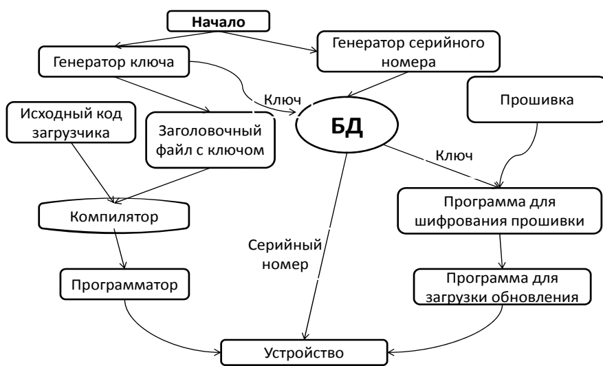
Рисунок 3 – Диаграмма процесса использования зашифрованных прошивок ключа
